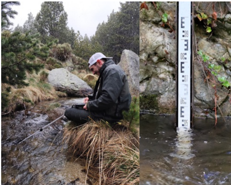
À gauche, mesure du débit (jaugeage) sur le Caillan. La répétition de cette opération est importante, elle permet de calibrer les échelles limnimétriques, à droite. Clichés : Antoine SÉNAC.
